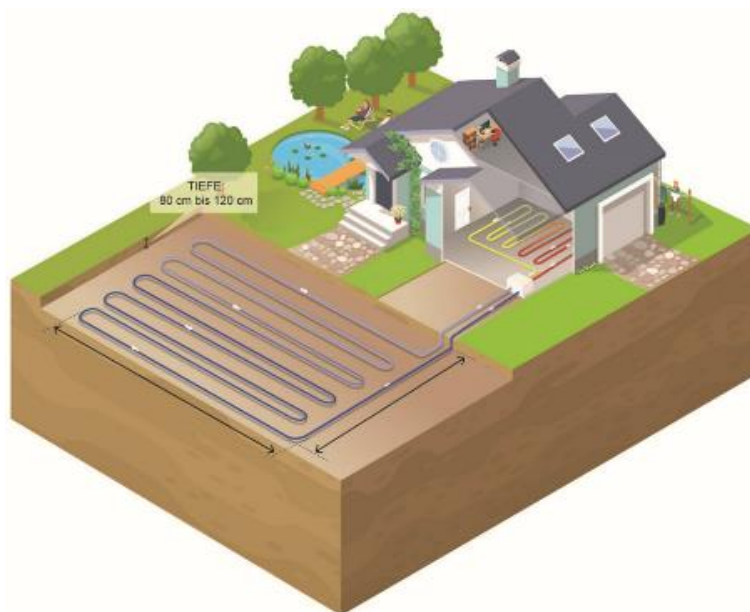
Abbildung 30: Der typische Aufbau eines Erdwärmekollektors (Bildquelle: Interreg Alpine Space Programme, Projekt GRETA).
