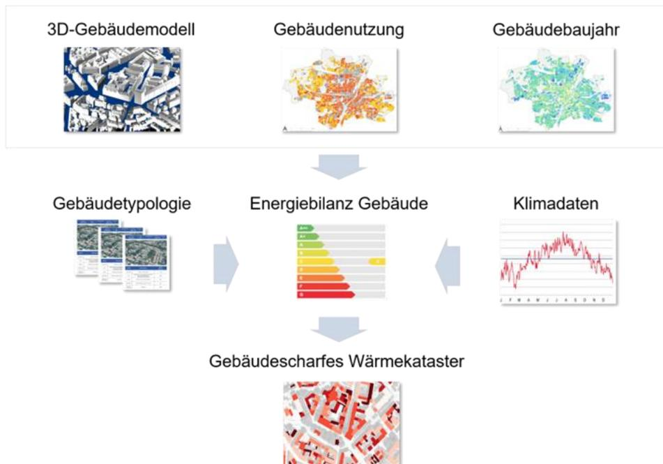
Abbildung 8: Schematische Darstellung zum Aufbau des gebäudescharfen Wärmekatasters.
