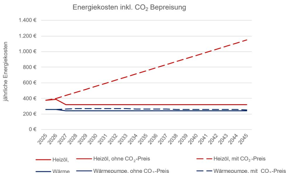
Bei einem Wärmebedarf von ca. 4.000 kWh liegen die Energiekosten der Wärmepumpe jährlich 80 € unter den Kosten der Ölheizung, wenn der CO<sub>2</sub>-Preis vernachlässigt wird. Mit CO<sub>2</sub>-Bepreisung wird die Differenz deutlich größer und kann 2045 bis zu 900 € betragen.
